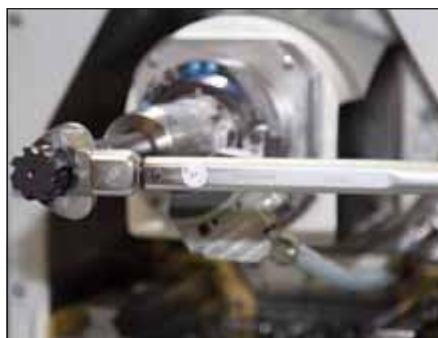
Den Wechselkopf mit Hilfe des Drehmomentschlüssels und dem passenden Mauleinsteckschlüssel mit angegebenem Anzugsdrehmoment festziehen (siehe Tabelle „Anzugsdrehmomente der Wechselköpfe“).
