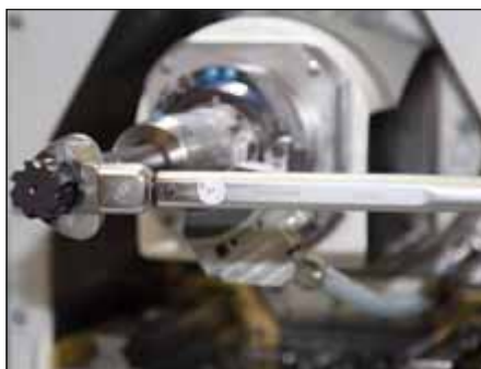
Den Drehmomentschlüssel möglichst horizontal am Wechselkopf anlegen und dabei nicht mit der Schlüsselfläche verkanten.
