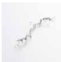
Späne eines herkömmlichen Gewindebohrers
