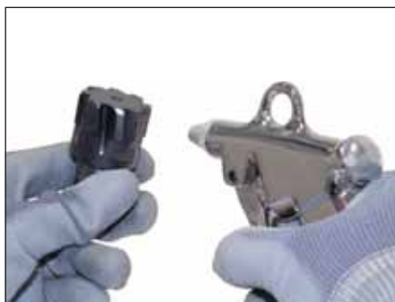
Den Wechselkopf an Kegel, Gewinde und Planfläche mit Druckluft und Tuch reinigen.
