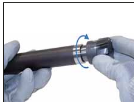
Den Wechselkopf im Uhrzeigersinn handfest in den Wechselkopfhalter eindrehen. Anschließend den Wechselkopfhalter samt Werkzeug in den Maschinenhalter einspannen.
