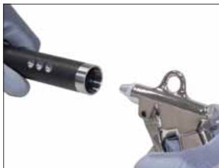
Den Wechselkopfhalter an Kegel, Gewinde und Planfläche mit Druckluft und Tuch reinigen.
